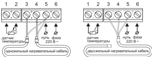
Рис. 4. Схема подключения к 2-х проводной сети питания нагревательных секций и матов
