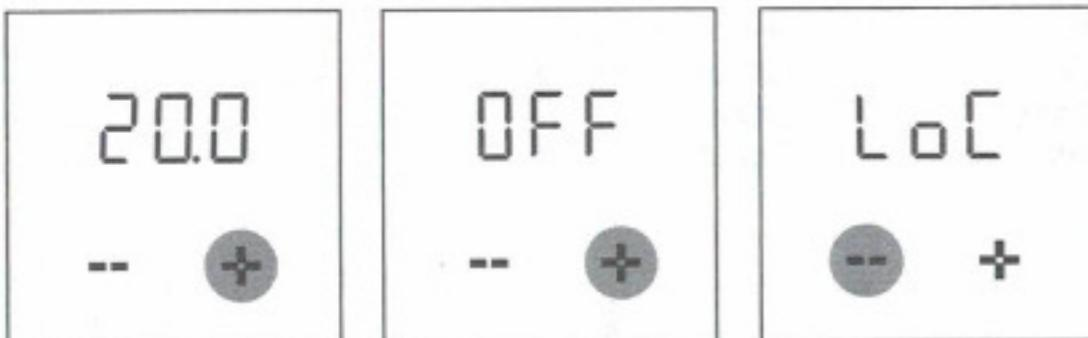
Когда функция защиты от замерзания включена, термостат будет поддерживать температуру пола на уровне 5 °C в состоянии отключения.
