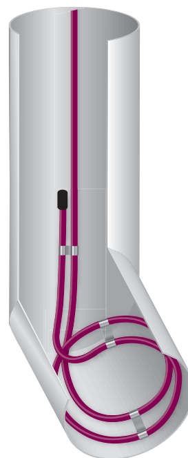
Рис. 30. Схема укладки кабеля внизу водосточной трубы
