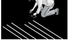
необходимо следить, чтобы шаг между прямолинейными отрезками кабеля был такой же, как между кабелем, закреплённым на сетке. Убедитесь, что соединение нагревательного элемента и силового кабеля (SPLICE) расположено таким образом, что монтажной длины
